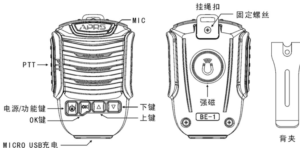
恢复出厂设置：开机状态同时按住电源键和 OK 键，“嘟”声恢复出厂设置并进入配对状态。
